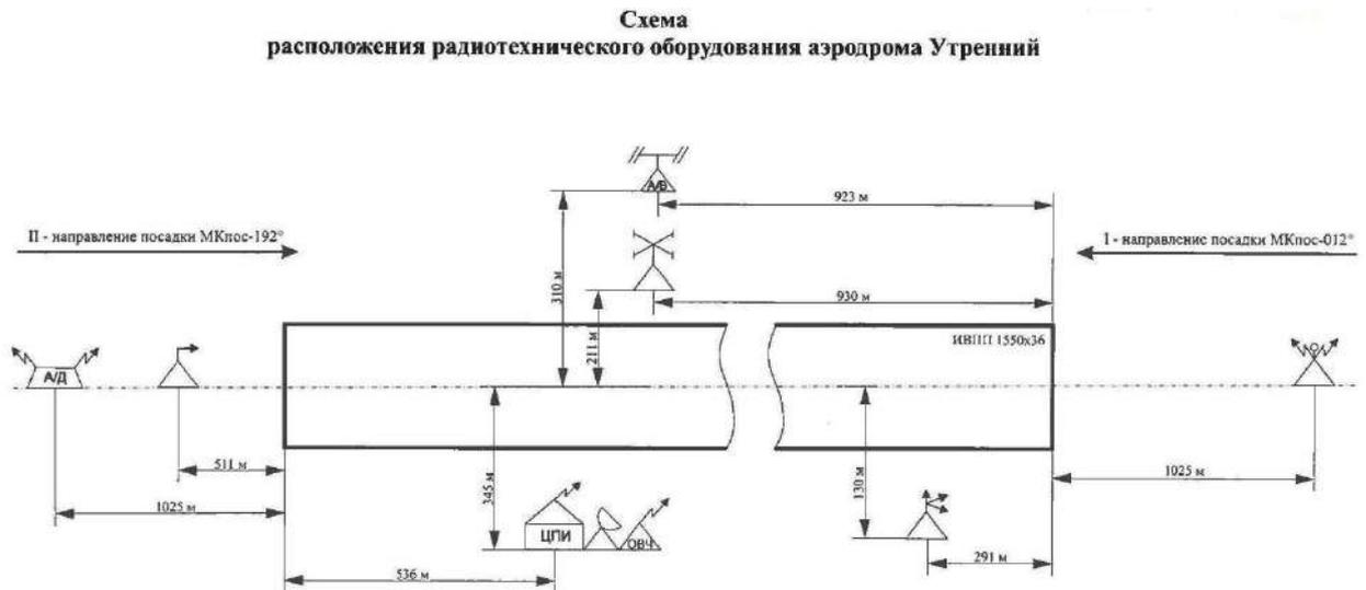
Рис. 14. Состав и размещение радиотехнического оборудования аэродрома
