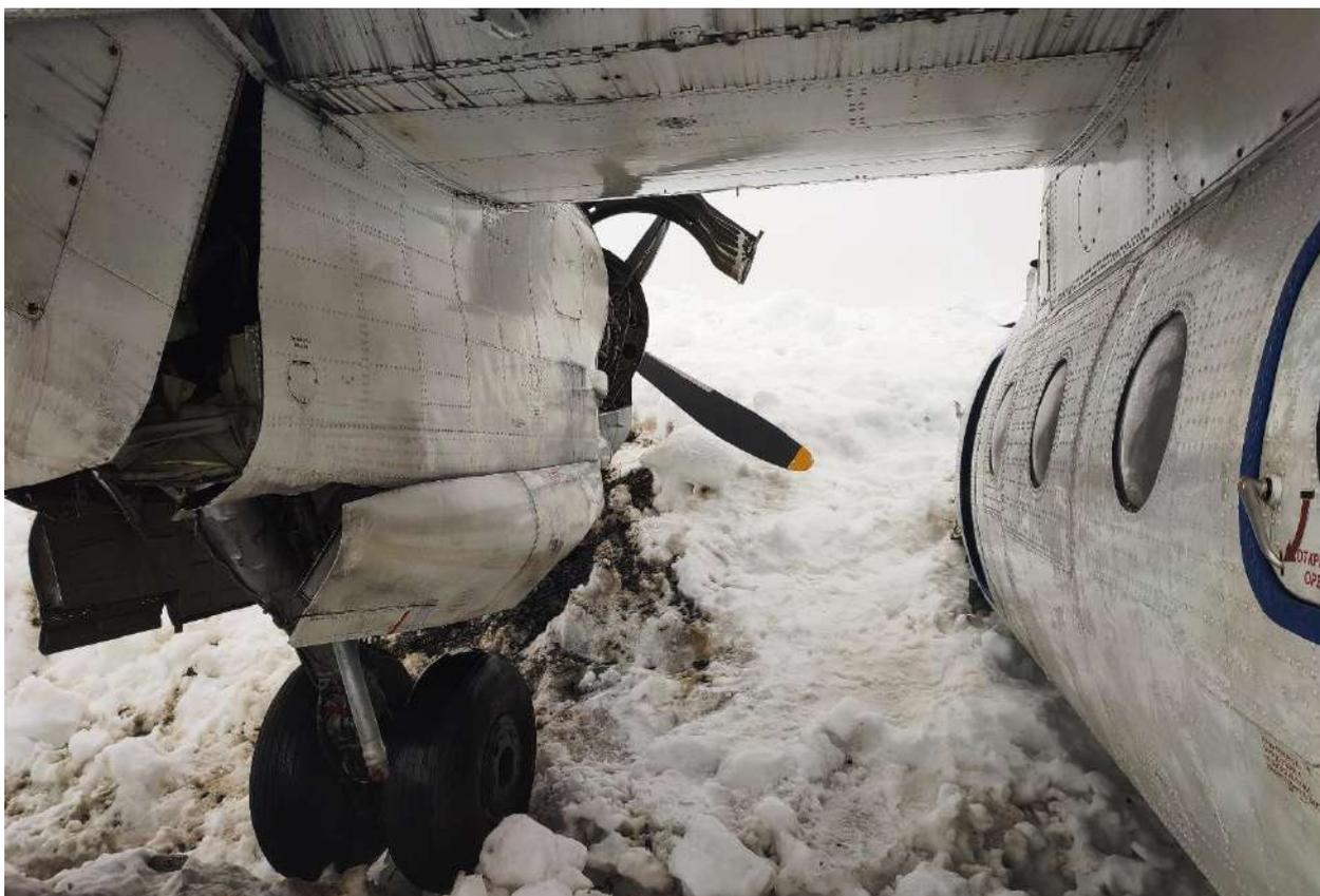
Рис. 11. Повреждения левой основной стойки шасси
