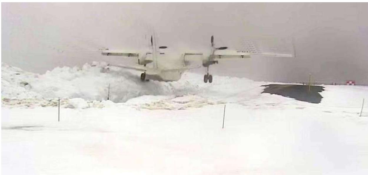
**Рис. 6. Столкновение Ан-26-100 RA-26662 со снежным бруствером (фотосъемка выполнена камерой, установленной на маяке VOR/DME)**
