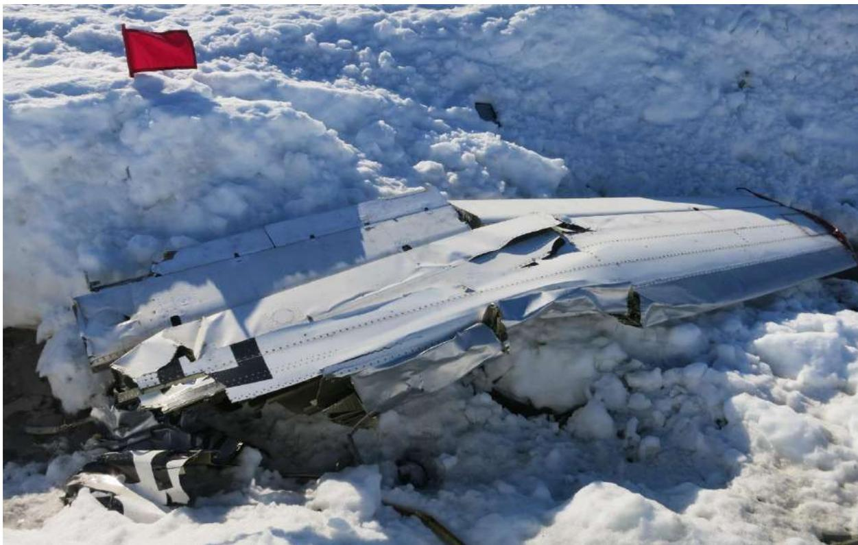
**Рис. 18.** Разрушенная отъемная часть левой консоли крыла на месте АП
